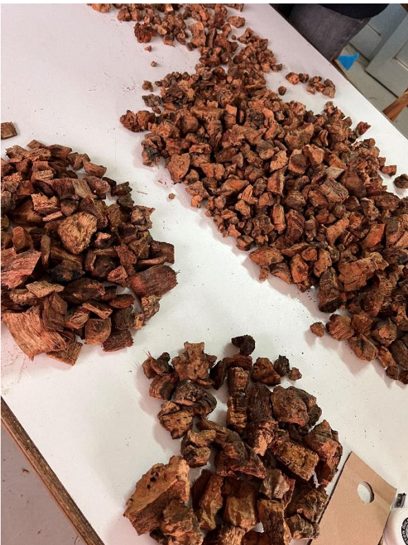
Fotografía 7. Separación manual de las partículas de corcho, las partículas mixtas y las partículas de madera
