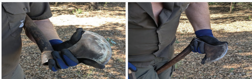
Images 11 et 12. Positions d'affûtage des deux côtés de la hache. Source : CICYTEX.
