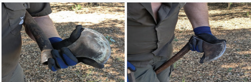
Imagens 11 e 12. Posições de afiação de ambos os lados do machado. Fonte: CICYTEX.
