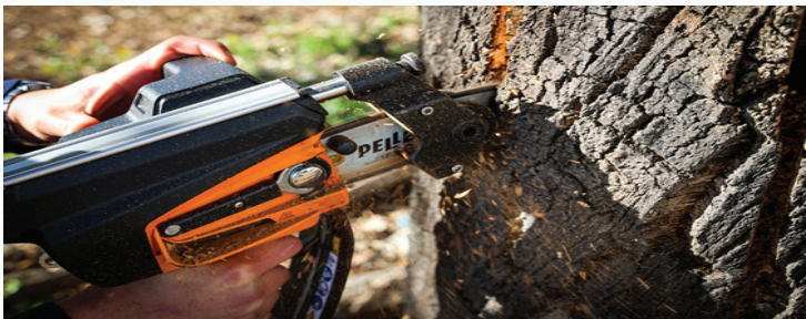
Imagem 6. Máquina de descortçamento da Corticeira Amorim. Fonte: CICYTEX.
