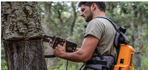
Imagem 5. Máquina COVELESS 3C18 durante a fase de traçar. Fonte: Institut Català del Suro.
