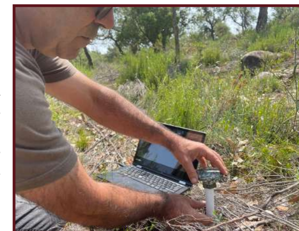
Revisión de estación de medición de temperatura y humedad en una parcela de control.
